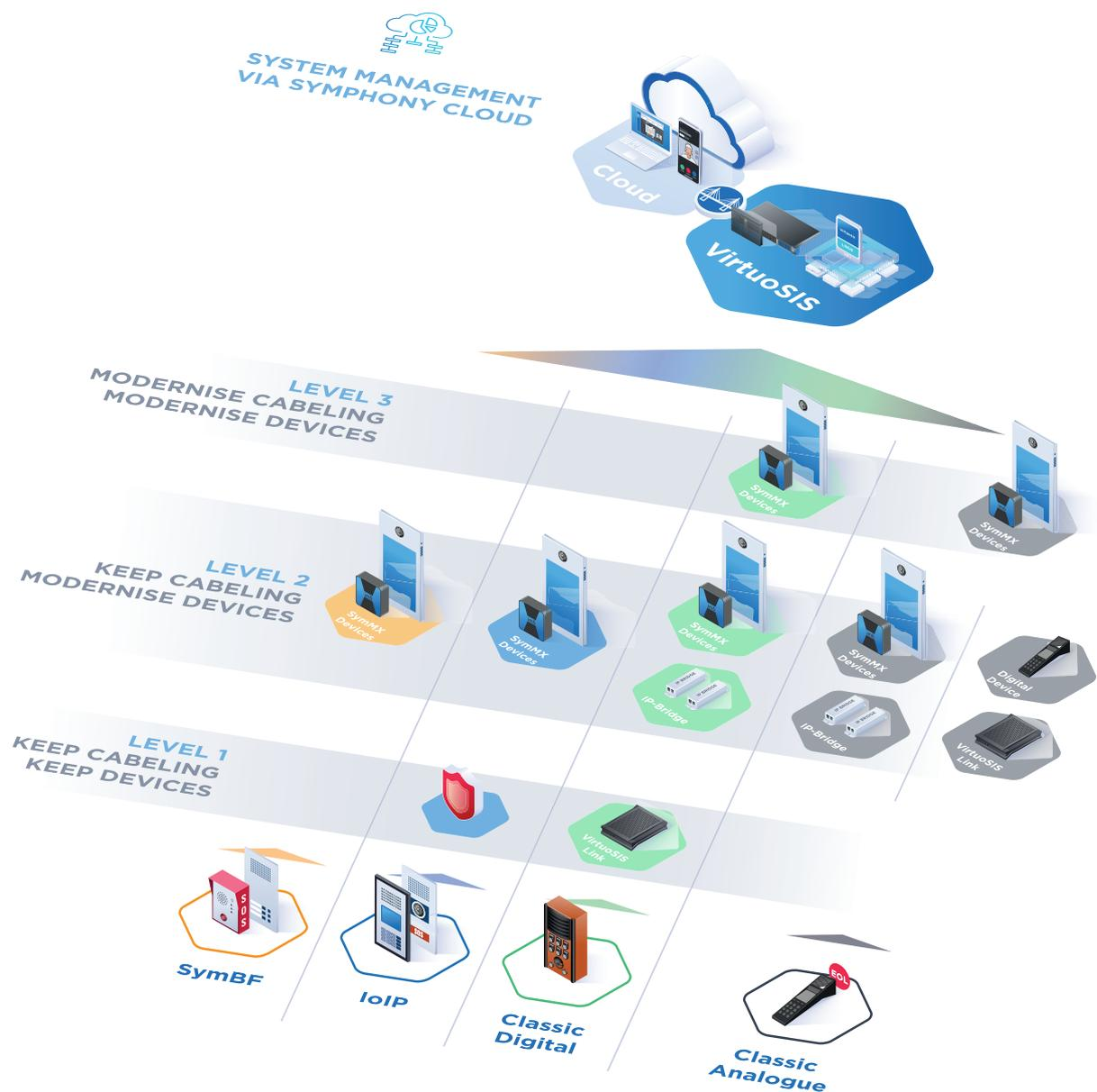
In der Abbildung sind die verfügbaren Aufrüstungs-Optionen für die einzelnen Systemtechnologien (Analog, Digital, IoIP) ersichtlich.
