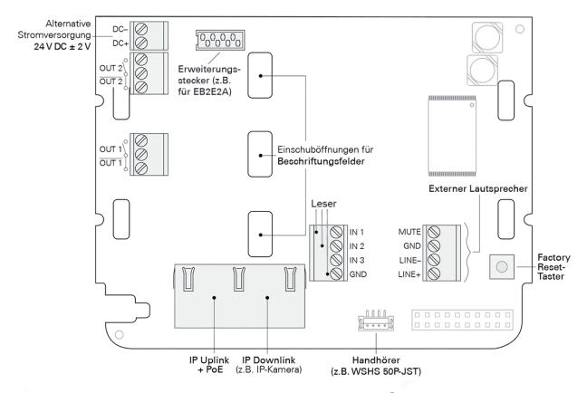
IN 1 - GND: RFID Leser Auslösung IN 2 - GND: RFID Leser Überwachung
