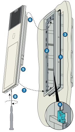
① Si nécessaire, collez le joint fourni sur le boîtier de montage. Veiller à ce que les flèches sur le cadre de montage soient bien orientées vers le haut.
