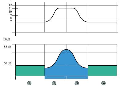
niveau de pression acoustique standard jusqu'à 60 dB ⇒ l'annonce est effectuée avec le niveau de volume prédéfini (dans cet exemple le niveau 7)
