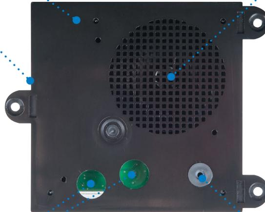
ET 962H: Der Integrierte Lautsprecher sorgt nicht nur für eine hohe Lautstärke und Sprachverständlichkeit, sondern ermöglicht auch die akustische Benutzerführung mittels automatisch abgespielter Sprachkonserven.
